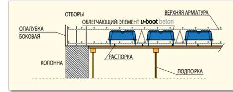
3 Завершается укладка арматуры, располагая сверху опалубки U-Boot Beton верхние штанги в двух направлениях, а также железные прутки для разрезания и пробивки, где это необходимо, согласно проекта.
